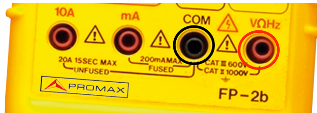
Figura Anexo I.5. Conexiones de las sondas para medir tensión.
