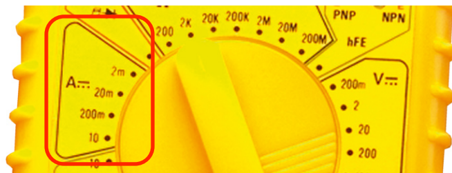
Figura Anexo I.3. Sector para medir intensidad de corriente continua.
