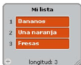
Inicialmente la lista estará vacía y su longitud será 0. Para agregar una casilla a la lista, presione el botón + ubicado en la parte inferior izquierda del monitor de lista. La longitud se incrementará en 1. Alternativamente, usted puede adicionar un elemento a la lista, usando bloques de lista como *añade algo a Mi lista*.
