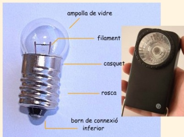
Parts d'una bombeta de llanterna de 3-6 V
