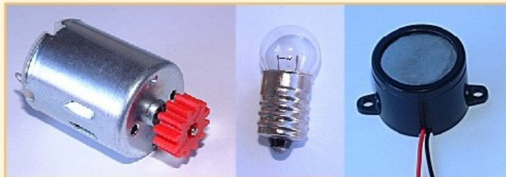
Receptors d'un circuit elèctric. De dreta a esquerra: bronzidor, bombeta i motor elèctric.
